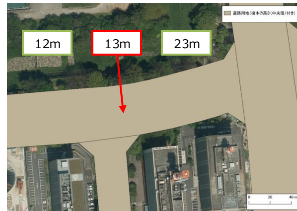
道路領域内の各樹木領域の最大値から 中央値を抽出して道路に付与
